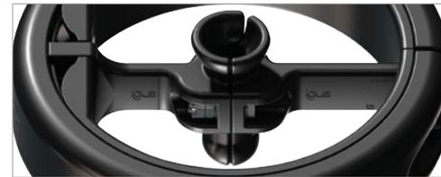
Der Innenkörper besteht aus vier Spritzgussteilen. Zwei davon bilden den Steg im Kettenglied und werden (verliersicher) verschraubt. Durch die Verschraubung klemmen sie auf dem Zugseil.
