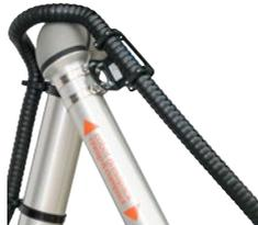
Federstabsystem ermöglicht eine nahezu kontaklose Führung von Leitungen am UR10/UR10e von Universal Robots
