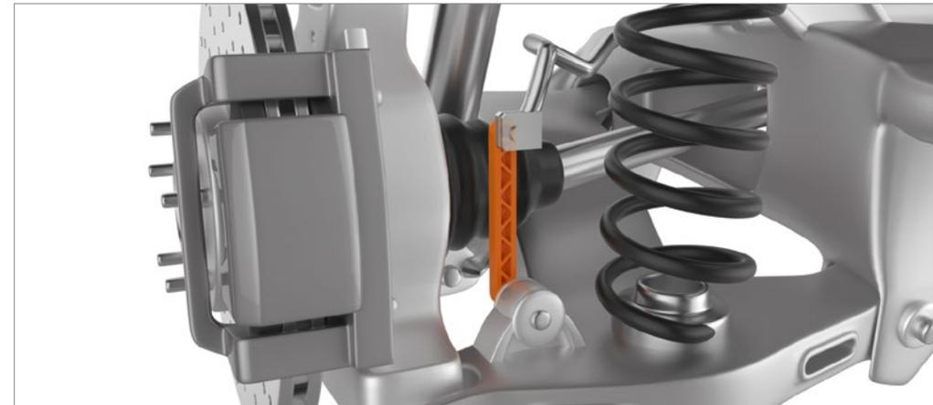
Koppelstange im Einsatz in einer PKW-Frontachse
